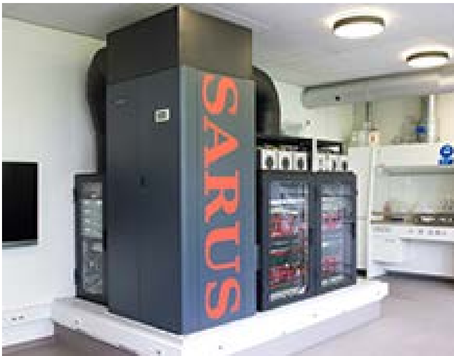
På billedet ses Sarus. Verdens kraftigste ultralydsskanner. Foto: DTU
