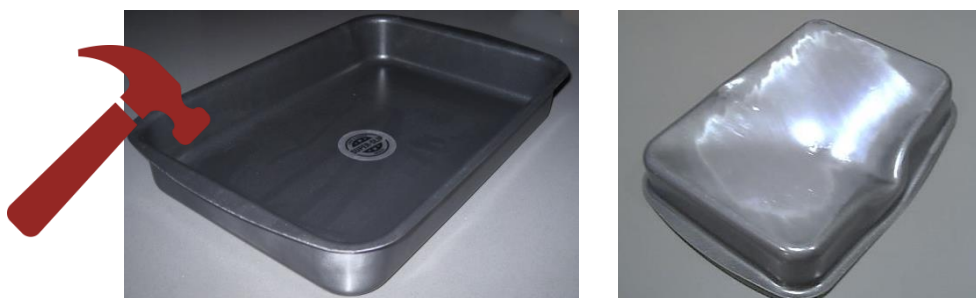
En metalbradepande før og efter et slag med en hammer. Metallet er deformeret, men der er ikke gået hul. Det skyldes metals lave flydestyrke, men høje brudstyrke.
