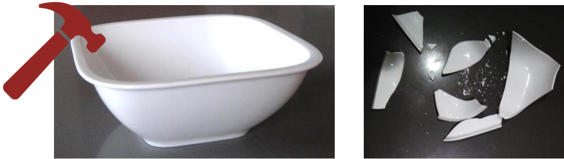
En porcelænsskål før og efter et slag med en hammer. Porcelænets smadres ved første slag. Det skyldes, at porcelæn ligesom andre keramer ikke kan ændre form. Materialet har lav flydestyrke.
