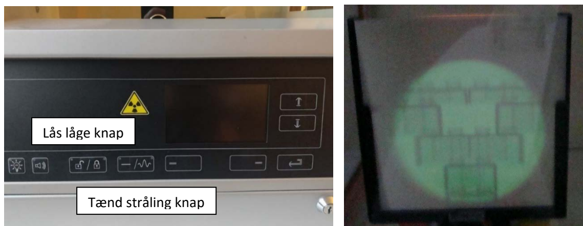
Figur 3 Røntgenbilledopstilling. Til venstre ses knapperne på røntgenapparatet. Til højre ses et røntgenbillede af en DUPLO-bro på en fluorescerende skærm monteret i apparatet. Bemærk at man nu ser intensitetsforskelle i skygebilledet.
